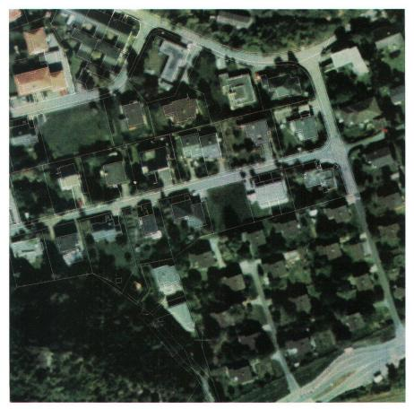
Abb. 3: Blonay: Digitales Orthophoto aus der Produktepalette «Swissphoto» überlagert mit Daten der amtlichen Vermessung.
