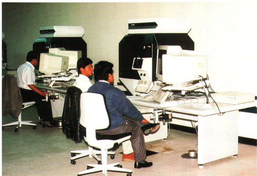
Abb.3: Analytische Photogrammetrie-Arbeitsstationen SD 2000 mit Bildeinspiegelung COLORISS.
