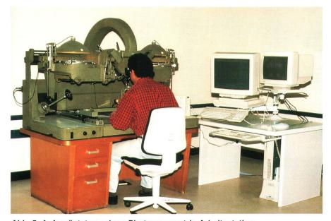
Abb. 5: Aufgerüstete analoge Photogrammetrie-Arbeitsstation.
