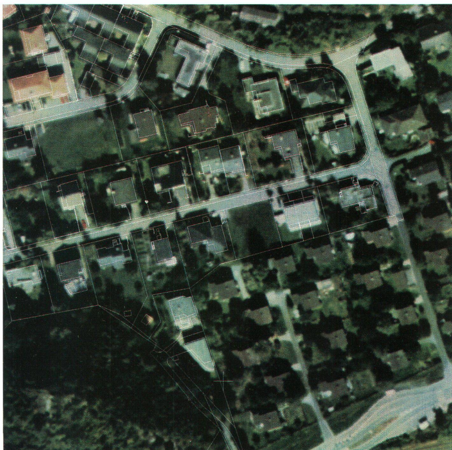
Abb. 3: Blonay: Digitales Orthophoto aus der Produktpalette «Swissphoto» überlagert mit Daten der amtlichen Vermessung.
