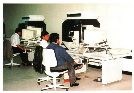
Abb.3: Analytische Photogrammetrie-Arbeitsstationen SD 2000 mit Bildeinspiegelung COLORISS.
