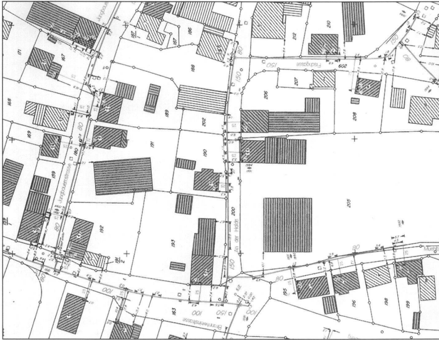
Abb. 2: Ausschnitt aus dem Gasplanwerk der Stadtwerke Heidenheim AG. Eine entsprechende Kopie wird im Auskunftsverfahren gegen Empfangsbestätigung an Tiefbauunternehmen gegeben. Das dazugehörige Sicherheitsmerkblatt ist hier nicht dargestellt.
