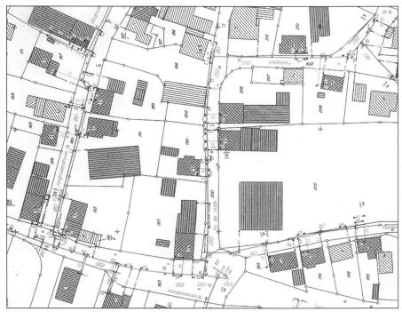
Abb. 2: Ausschnitt aus dem Gasplanwerk der Stadtwerke Heidenheim AG. Eine entsprechende Kopie wird im Auskunftsverfahren gegen Empfangsbestätigung an Tiefbauunternehmen gegeben. Das dazugeghörige Sicherheitsmerkblatt ist hier nicht dargestellt.
