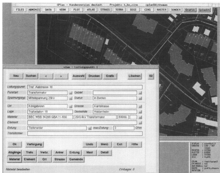
Abb. 3: Die Grafik, einzelne vermessungstechnische Punkt- und Liniendaten und der entsprechende Datensatz des Spartenmoduls können an einem Bildschirm dargestellt und bearbeitet werden.
