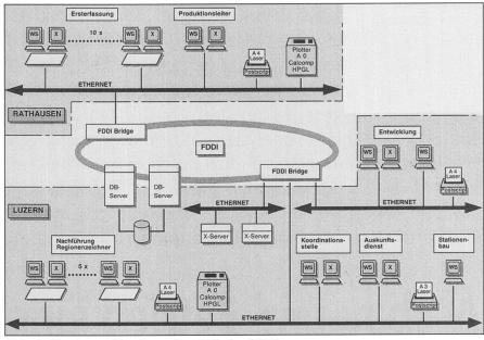
Abb. 2: Hardware-Konfiguration NIS der CKW.
