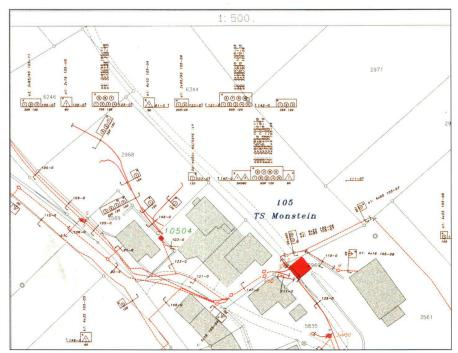
Abb. 3: Werkplan Elektrizitätswerk Davos: Ausschnitt Fraktion Monstein (1:500; verkleinert).
