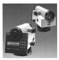
Für das wohl eintönigste Tätigkeitsfeld der Vermessung hat nun auch Zeiss mit zwei Digital-Nivellieren und der dazugehörenden Bar-Code-Latte die Automation eingeläutet. Neben höherer Genauigkeit – Standardabweichung für 1 km Doppelnivellement mit Präzisionscode-Latte 0,3 mm (DiNi10) bzw. 0,7 mm (DiNi20) – verfügt das DiNi10 gegenüber dem DiNi20 zusätzlich über die Möglichkeiten der Messzeiterfassung, weitere Nivellierverfahren einzusetzen und eine zusätzliche Justiermethode.
