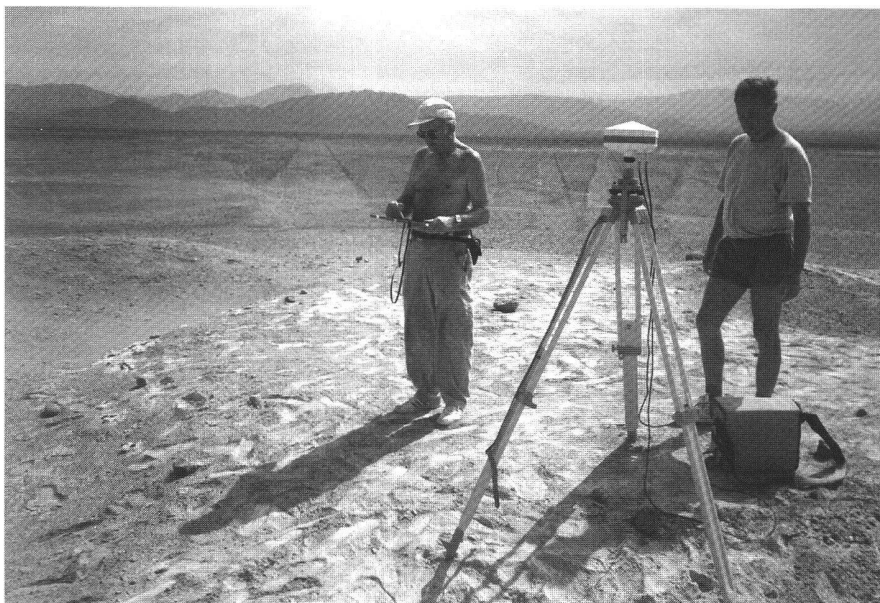
Azimet-Bestimmungen im Liniensystem «Estrella de Soisongo» mit dem Wild GPS-System 200.
