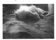
Abb. 1: Nachbildung einer Staublawine im physikalischen Modell.
