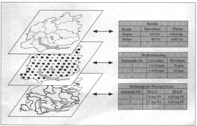
Abb. 1: Schematische Darstellung für die Speicherung bzw. Kombinierung von verschiedenen Datenebenen: links digitalisierte Karten, rechts zugehörige Angaben in der Datenbank.
