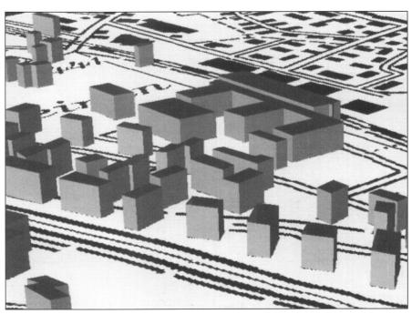
Abb. 8: 3D-Visualisierung von automatisch erkannten Gebäuden (Vordergrund), Pixelkarte und DHM25.
