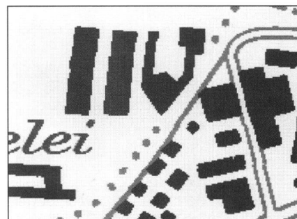
Abb. 5: Pixelkarte mit erkannten flächenförmigen Objekten (dunkel).
