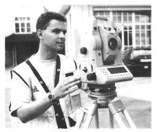
Macht die Zielerfassung auf handelsübliche Reflektorprismen doppelt so schnell und bequem wie bisher: ATR1, Automatische Zielerfassung in den neuen TCA1100 und TCA1800 Tachymetern von Leica.
