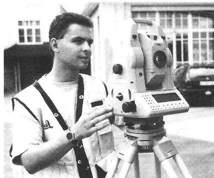
**Macht die Zielerfassung auf handelsübliche Reflektorprismen doppelt so schnell und bequem wie bisher: ATR1, Automatische Zielerfassung in den neuen TCA1100 und TCA1800 Tachymetern von Leica.**
