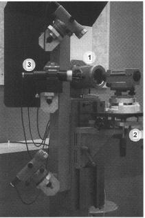
Abb. 2: Kollimator-Prüfplatz für Nivellierinstrumente: 1 Prüfkollimator, 2 Vorrichtung zur Erzeugung von Längs- und Querneigungen, 3 Spezial-Kollimator zur Ziellinienuntersuchung.
