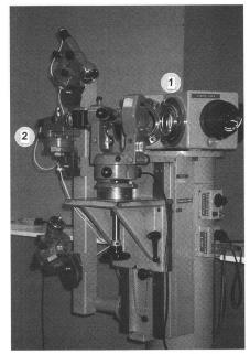
Abb. 1: Kollimator-Prüfplatz für Theodolite nach Kneissl: 1 Winkelkollimator, 2 Kollimator-Vertikalschnitt.
