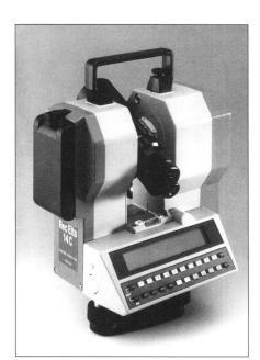
Neues DOS Computer-Tachymeter Rec Elta 14 C von Carl Zeiss.
