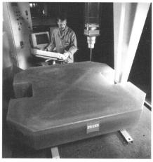
Abb. 2: Der Zerodur-Glaskeramikblock wird in Oberkochen mit einem Zeiss Koordinatenmessgerät auf seine geometrische Form hin geprüft.
