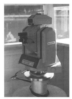
Abb. 2: Messroboter TM 3000 V/D.
