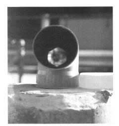
Abb. 3: Zielpunkt (Reflektor) mit Witterungsschutz.
