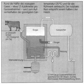
Abb. 7: Schema einer landwirtschaftlichen Biogasanlage.
