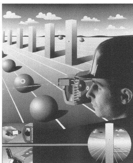
Ein Zusatzfernrohr BFT1 mit fünffacher Vergrößerung erlaubt Entfernungsmessungen auf detaillierte Nahziele wie Altbaufassaden, strukturierte Oberflächen oder auf Zieltafeln bis 100 m.
