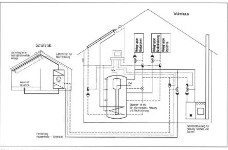
Abb. 4: Prinzipschema Energiekonzept Hof Strickmatt.
