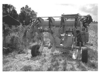
Abb. 2: Tieflockerungsgerät MM 100.
