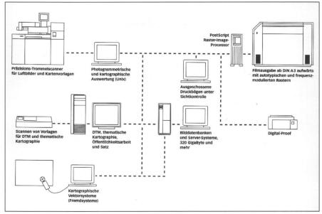
Darstellung einer möglichen Konfiguration von MERKARTOR, dem «modularen EDVund Recorder-System für Kartographie, Typographie und Orthophotos». Linotype-Hell bietet damit ein komplettes, modular ausbaubares Hard- und Softwaresystem an, das über offene Schnittstellen Fremddaten übernehmen kann.
