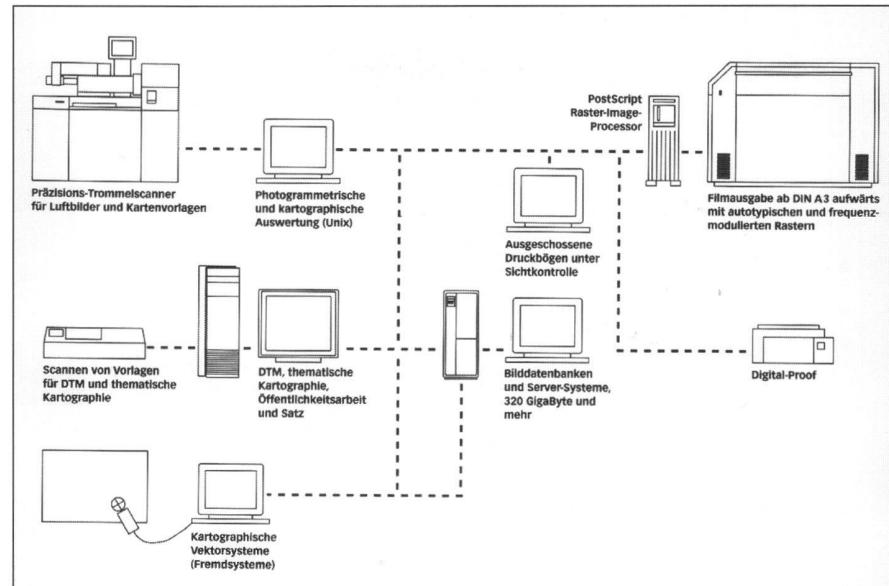
**Darstellung einer möglichen Konfiguration von MERKATOR, dem «modularen EDV- und Recorder-System für Kartographie, Typographie und Orthophotos».** Linotype-Hell bietet damit ein komplettes, modular ausbaubares Hard- und Softwaresystem an, das über offene Schnittstellen Fremddaten übernehmen kann.
