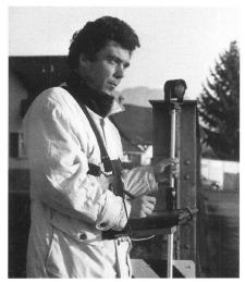
En vue des applications topographiques, Leica a élaboré un support permettant de fixer le Penpad au trépied ou à une armature à partir de laquelle le topographe aura à tout moment la possibilité de travailler avec l'ordinateur. Cette fixation réglable peut être adaptée à différents modèles Penpad.
