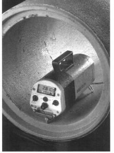
WILD PLA20, netzunabhängiger Hochleistungs-Kanalbaulaser von Leica.
