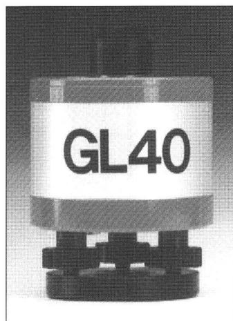
Der kleine Rotationslaser im Ganzmetallgehäuse mit sichtbarem Laserstrahl kann horizontal und vertikal eingesetzt werden. Mit Hilfe der Dreifuss-schrauben werden die genauen Libellen schnell und leicht eingestellt. Die Umdrehung des Rotorkopfes kann stufenlos bis zum Stand reguliert werden. Der integrierte Strahlteilerkopf ermöglicht eine schnelle Absteckung rechter Winkel.
