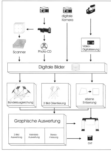
Abb. 1: Systemkomponenten und Verfahrensablauf.
