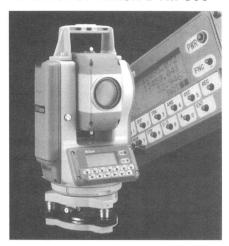
Die neue Totalstation DTM-300 von Nikon hilft die täglich anfallenden Arbeiten der Bauvermessung, der Katastervermessung und der Architekturvermessung, einfach und schnell zu erledigen. Dazu trägt das breite Spektrum von Vermessungsprogrammen und der grosse Datenspeicher bei.
