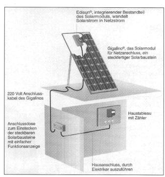
Abb. 12: Projekt Gigawatt: steckerfertige Solarmodule Gigalino.
