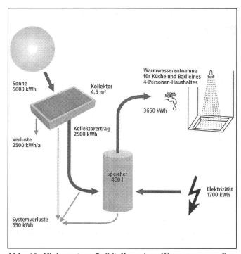
Abb. 13: Kleinsystem Solkit für solare Warmwasseraufbereitung.
