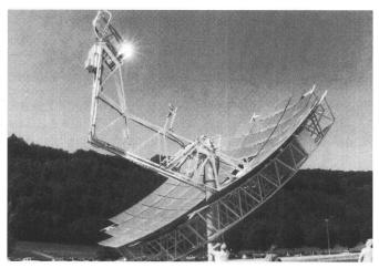
Abb. 14: PSI-Solarkonzentrator für die Produktion von solarem Wasserstoff.
