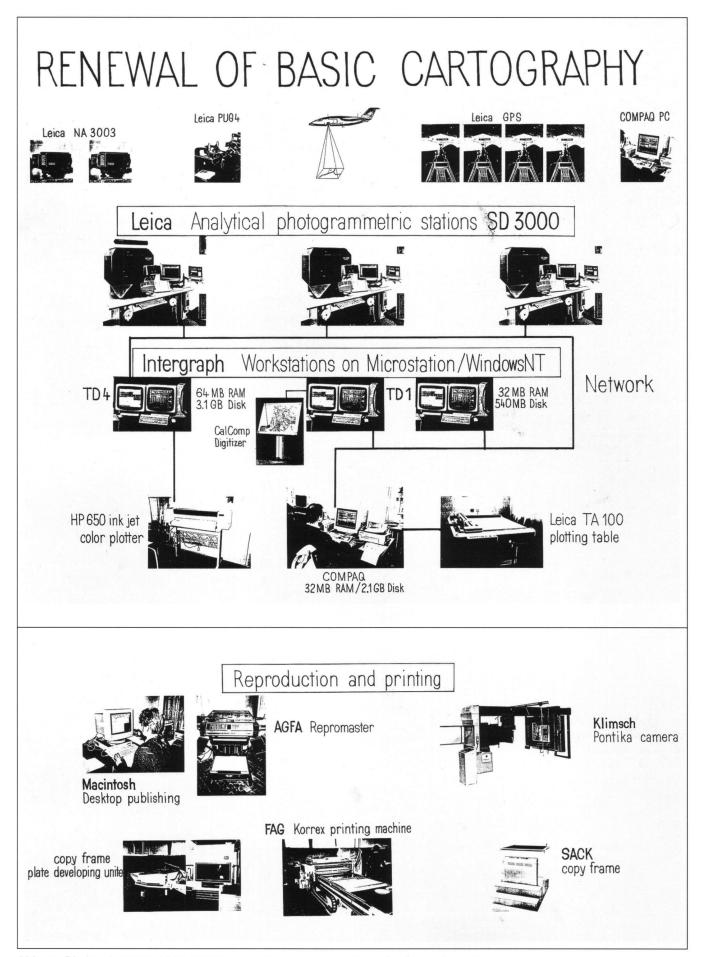
Abb. 15: Die im «Institute of Aerial Photogeodesy» neu installierte Gerätekonfiguration.
