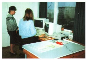
Abb. 4: Intergraph TD-1 Workstation mit Calcomp Digitalisiertisch.
