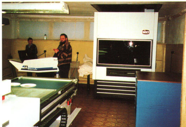
Abb. 7: SIXT Druckplattenkopierautomat (rechts) und LASTRA Plattenentwicklungsmaschine (links).
