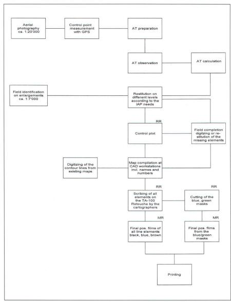
Abb. 1: Produktionsablauf zur Herstellung der digitalen Basiskarte 1:10 000.
