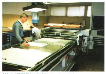
Abb. 8: KORREX 2000 Offsetdruckmaschine.
