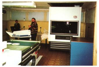
Abb.7: SIXT Druckplattenkopierautomat (rechts) und LASTRA Plattenentwicklungsmaschine (links).
