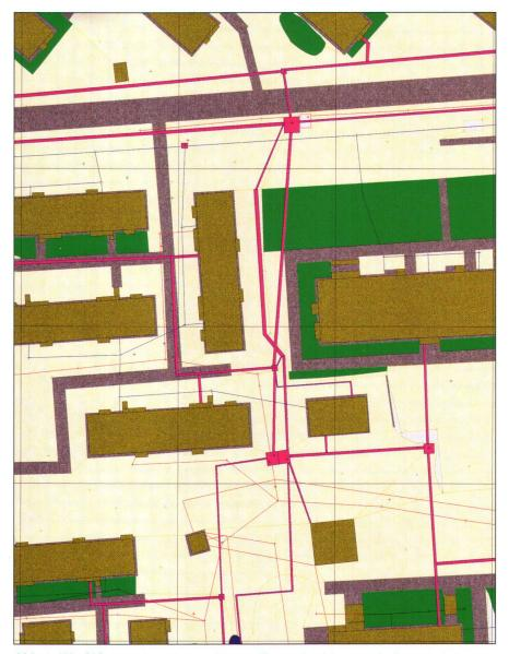
Abb. 3: WinGIS verwaltet die graphische Ebene des Liegenschaften- und des Leitungskatasters für Wasser, Abwasser, Elektrizität etc. Für die technische Gemeindeverwaltung steht damit eine Software-Reihe zur Verfügung, welche unter Windows die Wünsche der Gemeindetechniker abdeckt.
