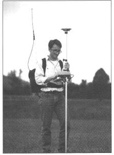
Absteckung mit dem GPS-System 300 von Leica.
