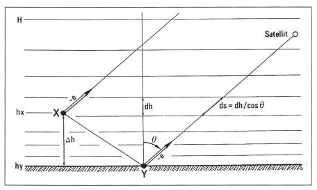
Abb. 1: Situation bei der Messung der Höhendifferenz zweier Stationen X und Y in einer horizontal geschichteten Atmosphäre.
