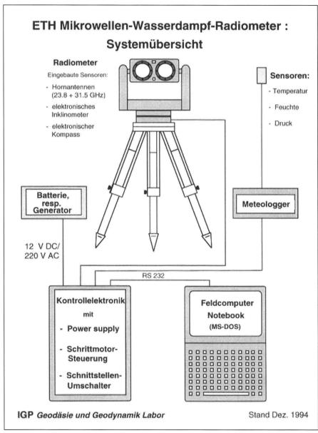
Abb. 2: Die Komponenten des Radiometer-Messsystems des GGL-IGP.
