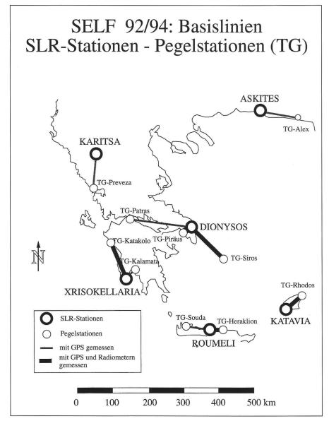
Abb. 10: Pegelstationen in Griechenland, die im Zuge des SELF-Projektes 1992 und 1994 mit GPS und Radiometetrie an ein einheitliches globales Koordinatensystem angeschlossen wurden.
