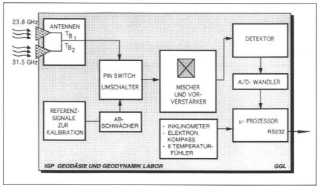
Abb. 3: Zum Funktionsprinzip der Mikrowellen-Wasserdampf-Radiometer.
