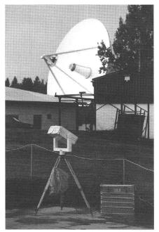
Abb. 6: Das GGL-IGP Wasserdampf-Radiometer in messbereiter Aufstellung während einer Messkampagne bei der Satellitenbeobachtungsstation des Instituts für Angewandte Geodäsie (IfAG) in Wettzell (Bayerischer Wald). Im Hintergrund ist das für VLBI eingesetzte Radioteleskop sichtbar. Die Steuerung des Radiometer-Messsystems wird durch einen MS-DOS Notebook PC durchgeführt, der in der Transportkiste neben dem Gerät untergebracht ist.
