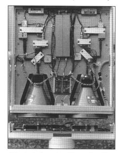
Abb. 4: Aufbau der Mikrowellen-Bauteile auf der Grundplatte des Radiometers. Unterhalb der senkrecht gestellten Hornantennen sieht man die geöffnete Montierung und die eingebauten Schrittmotoren für den Antrieb des Radiometers in Azimut und Elevation.
