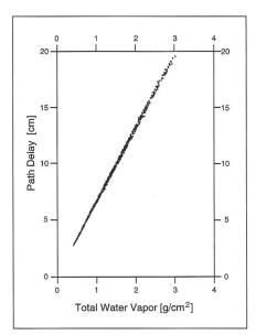
Abb. 1: Zusammenhang zwischen dem totalen Wasserdampfgehalt in der Atmosphäre und der dadurch entstehenden Verlängerung (sog. Path Delays) der gemessenen Distanzen zu den Satelliten, die in Extremfällen ca. 40 cm erreichen können.
