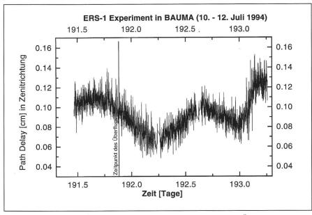
Abb. 8: Gemessener Verlauf des Path Delays vor und nach dem Überflug des ERS-1 Satelliten in Bauma am 10. Juli 1994. Die Messreihe besteht aus über 5700 Einzelmessungen. Der Streubereich der Signale entsteht dadurch, dass die in unterschiedlichen Elevationen und Azimuten durchgeführten Einzelmessungen in den Zenit umgerechnet, und damit Inhomogenitäten über den ganzen Horizont gleich behandelt werden.
