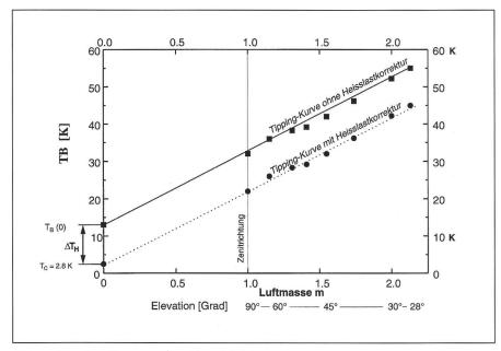
Abb. 7: Tipping-Kurve vor und nach Einbezug der Heisslastkorrektur  $\Delta T_{\rm H}$ .
