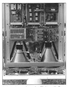
Abb. 5: Anorndung der Elektronik-Baugruppen im Radiometer.
