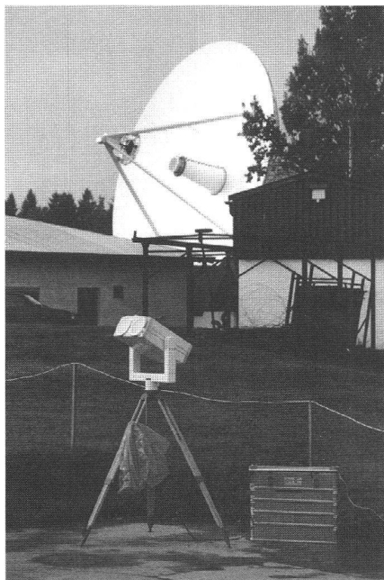
Abb. 6: Das GGL-IGP Wasserdampf-Radiometer in messbereiter Aufstellung während einer Messkampagne bei der Satellitenbeobachtungsstation des Instituts für Angewandte Geodäsie (IfAG) in Wetzell (Bayerischer Wald). Im Hintergrund ist das für VLBI eingesetzte Radioteleskop sichtbar. Die Steuerung des Radiometer-Messsystems wird durch einen MS-DOS Notebook PC durchgeführt, der in der Transportkiste neben dem Gerät untergebracht ist.
