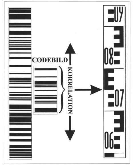
Abb. 5: Grundprinzip der Korrelation beim Wild-Digitalnivellier.
