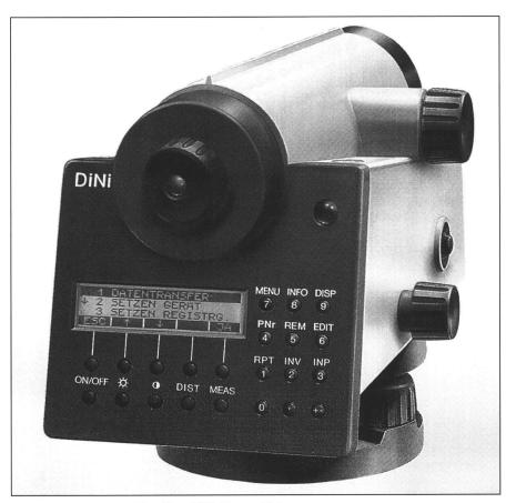
Abb. 3: Das digitale Nivellier DiNi 10 von Zeiss.
