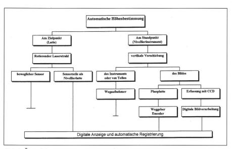
Abb.1: Übersicht automatisierte Höhenmesssysteme.
