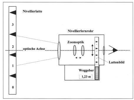
Abb. 2: Grundprinzip des Bonner «Digitalnivelliers».
