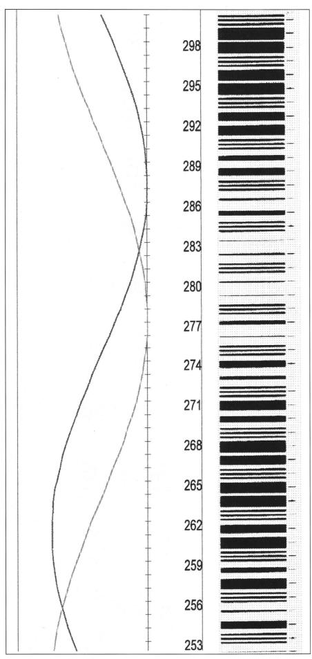
Abb. 7: Grundprinzip des Topcon Codes.
