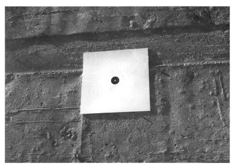
Abb. 5a: Photogrammetrische und geodätische Punktsignalisierung.
