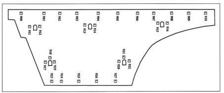
Abb. 2: Verteilung der signalisierten Punkte an der Staumauer Luzzone.
