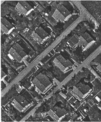
Abb. 5a: Unkorrigiertes Orthobild. Die Häuser erscheinen «umgeklappt».
