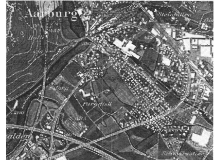
Abb. 8: Orthobild mit überlagerter Pixelkarten-Information.
