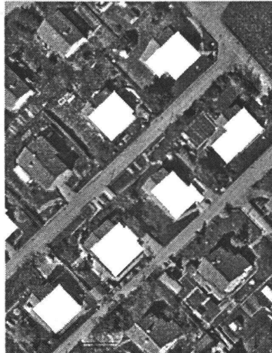
Abb. 5b: Korrigierte Dachlagen im Orthobild (zur Veranschaulichung weiss dargestellt).
