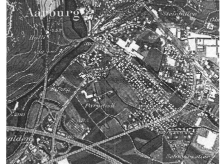
Abb. 8: Orthobild mit überlagerter Pixelkarten-Information.
