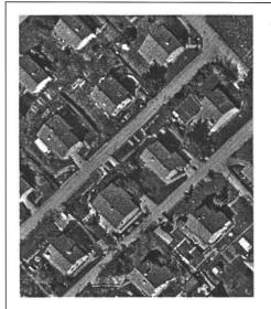
Abb. 5a: Unkorrigiertes Orthobild. Die Häuser erscheinen «umgeklappt».
