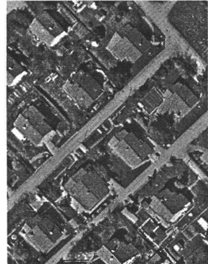
Abb. 5c: Korrigierte Dachlagen in richtiger Grauwertdarstellung. Der «alte Dachrest» bleibt noch sichtbar bestehen.
