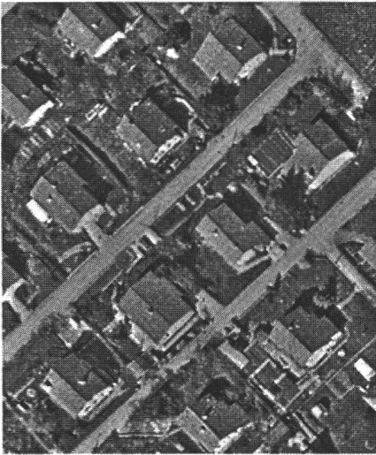
Abb. 5a: Unkorrigiertes Orthobild. Die Häuser erscheinen «umgeklappt».
