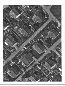
Abb. 5c: Korrigierte Dachlagen in richtiger Grauwertdarstellung. Der «alte Dachrest» bleibt noch sichtbar bestehen.
