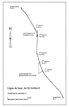
Fig. 5: Tracé de la variante 2 et points de jonction prévus.
