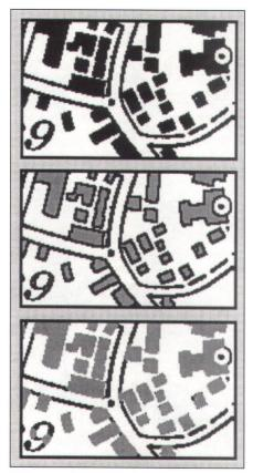
Abb. 3: Grundprinzip der Flächen-Linien-Trennung durch lokale Rasteroperationen.
