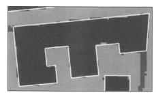
Abb. 7: Ausgeglichene Gebäudekanten.
