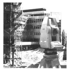
TC400 Tachymeter von Leica.
