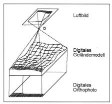
Abb. 1: Geometrisches Modell der digitalen Orthophotoerzeugung.
