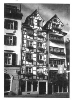
Le redressement d'image est une solution simple et rapide permettant l'élaboration d'un plan de façade à partir d'une photo. La prise de vue est effectuée à l'aide d'un appareil réflex standard. La mise à l'échelle est issue de distances mesurées dans l'objet ou d'un quadrilatère de points de contrôle connus en coordonnées. La mesure de la hauteur, largeur et diagonale d'une ouverture permet déjà la mise à l'échelle du modèle.
