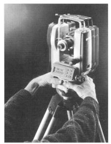
Leica T100 - Elektronischer Bautheodolit.
