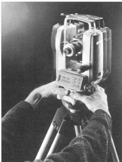
Leica T100 – Elektronischer Bautheodolit.
