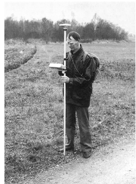
Abb. 3: Einsatz «Stop and Go»: AT201/CR233 auf Lotstock, SR261/GEB70 im Rucksack.
