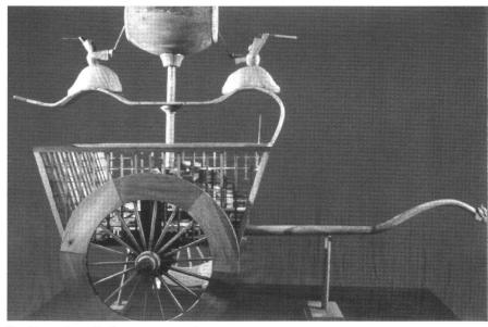
Nachbau eines Entfernungsmesskarrens.
