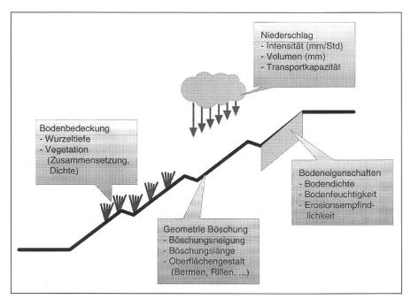
Abb. 1: Oberflächenerosion auf Hängen und Böschungen. Die vier Haupteinflussgrössen sind Niederschläge, Bodeneigenschaften, Böschungsgeometrie und -oberfläche sowie Vegetationsdecke.
