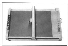
Der A3/A4 Plotter IP-220 von MUTOH ist ein universeller A3 Plotter für verschiedene Anwendungsbereiche. Je nach Anforderung kann der IP-220 als Zeichenplotter für CAD Anwendungen, in Verbindung mit den speziellen Malstiften als Malplotter für Schilder oder mit dem Schneideinsatz als Schneidplotter für Schriften, Logos etc. eingesetzt werden.
