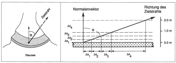
Abb. 7: Staumauer. Bestimmung des Einflusses der einzelnen Gradientenbereiche auf die horizontale Zielungen.
