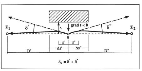
Abb. 3: Stationspunkt (S) im Objektbereich, im Abstand x vom Objekt. Zielpunkte (Z1, Z2) ausserhalb des Objektbereiches.
