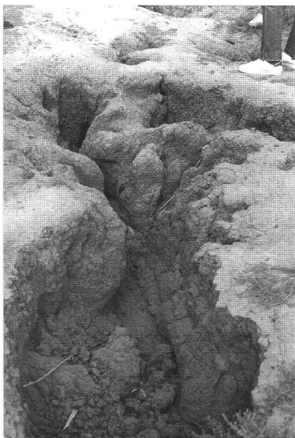
Abb. 2: «Innerer» Kollaps von instabilen Böden nach ungeeignetem Reisanbau unter Bewässerung, Mauretanien, 1985. (Foto A. Mauderli.)
