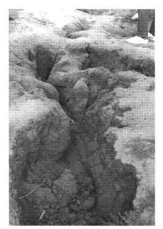
Abb. 2: «Innerer» Kollaps von instabilen Böden nach ungeeignetem Reisanbau unter Bewässerung, Mauretanien, 1985. (Foto A. Mauderli.)
