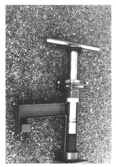
Abb. 3: Bangladesh/Indien, Schnitt durch den Pumpenkopf der TARA-Handpumpe; Die Entwicklung angepasster Technologien stellt hohe Anforderungen, damit sie lokal hergestellt und auf Dorfebene gewartet werden können. (Foto: E. Baumann, SKAT, St. Gallen.)
