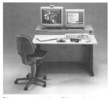
Photogrammetrisches Bildverarbeitungssystem PHODIS mit neuem digitalem Stereoplotter PHODIS ST von Carl Zeiss.
