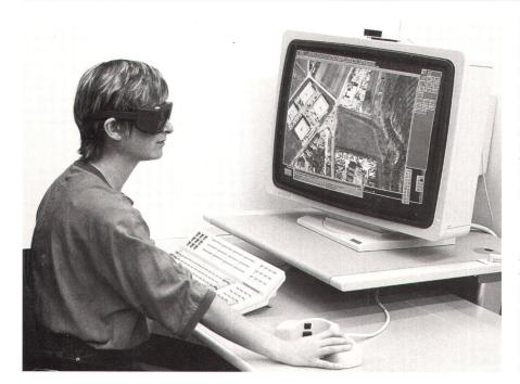
Überlagerung der Stereoluftbilder mit den geometrischen Daten eines GIS-Systems ist sehr einfach möglich und erlaubt eine sehr effiziente Kontrolle der Information und deren Nachführung (vgl. [4]). Freilich ist zu beachten, dass die Stereoüberlagerung nur möglich ist, wenn die geometrischen Referenzdaten nicht nur Lagekoordinaten, sondern auch die Höhen enthalten
