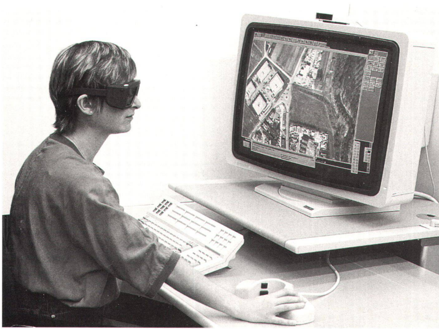
Abb. 6: Digitale photogrammetrische Arbeitsstation ImageStation von Intergraph. Der Operateur betrachtet das Stereobild über eine Flickerbrille (liquid cristal eye shutters). Zur Steuerung der Messmarke im Stereobild steht eine Maus zur Verfügung, deren Position über einen Digitalisiertisch dem Gerät übermittelt wird.
