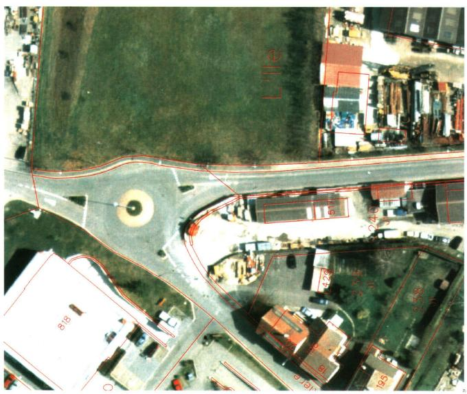
Abb. 7: Digitales Orthophoto in Farbe mit überlagertem Inhalt eines Grundbuchplans. Das Farbbild wurde mit dem digitalen Geländemodell des Bundesamtes für Landestopographie in ein Orthophoto umgewandelt (der Grundbuchplan wurde uns freundlicherweise von der «Direction des mensurations du Canton de Vaud» zur Verfügung gestellt).
