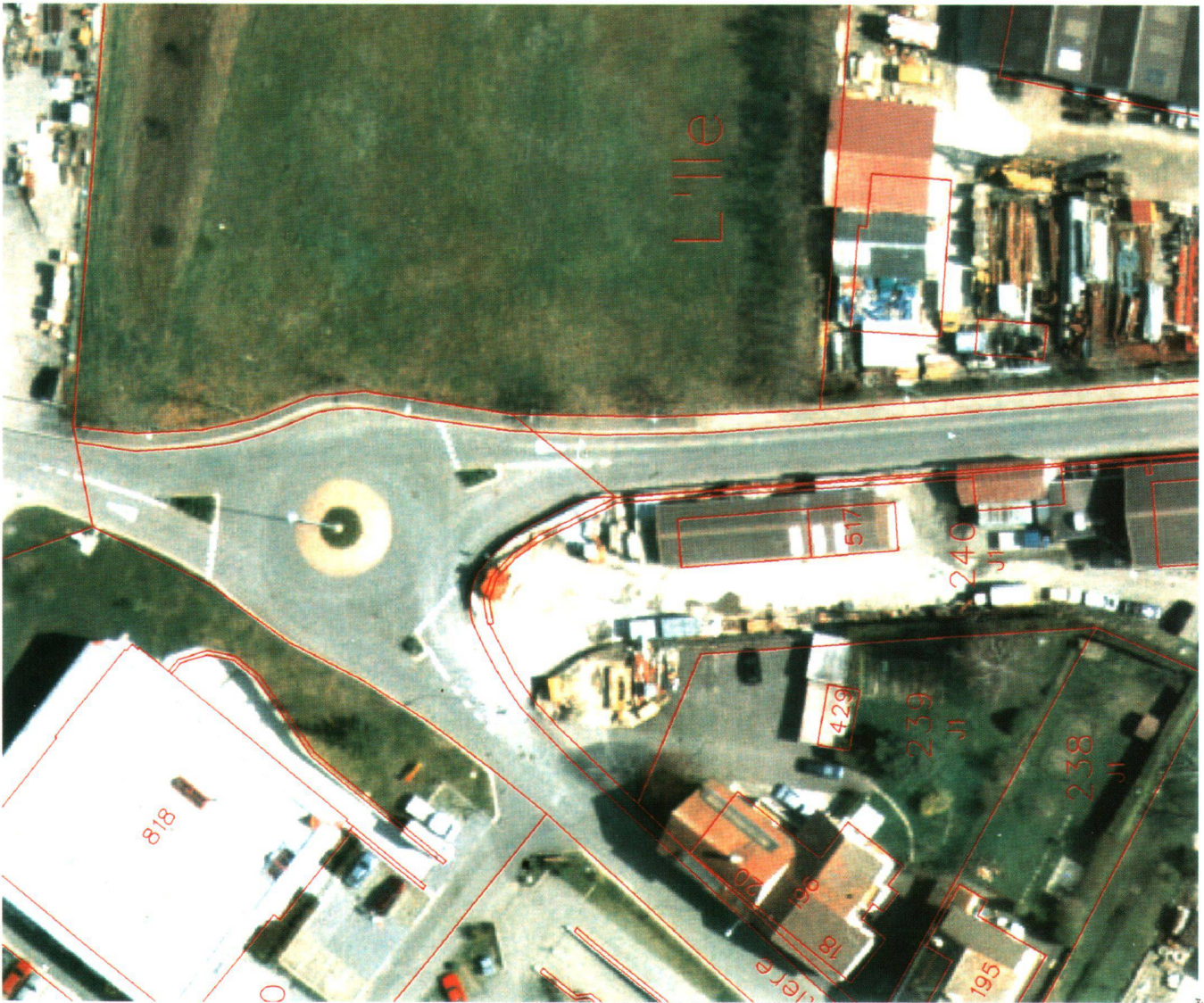
Abb. 7: Digitales Orthophoto in Farbe mit überlagertem Inhalt eines Grundbuchplans. Das Farbbild wurde mit dem digitalen Geländemodell des Bundesamtes für Landestopographie in ein Orthophoto umgewandelt (der Grundbuchplan wurde uns freundlicherweise von der «Direction des mensurations du Canton de Vaud» zur Verfügung gestellt).
