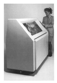
bei traditionellen Siebdruck- und Offset-Techniken nötig sind, kann verzichtet werden. Dank dieser neuen Technik erreicht man Durchlaufzeiten von etwas mehr als einer Minute pro m² Vierfarbendruck. Der Drucker verarbeitet Opaque- und Transparentpapier von 75–150 g sowie Polyesterfolie und kann Materialrollen von 151 Meter Länge aufnehmen.
