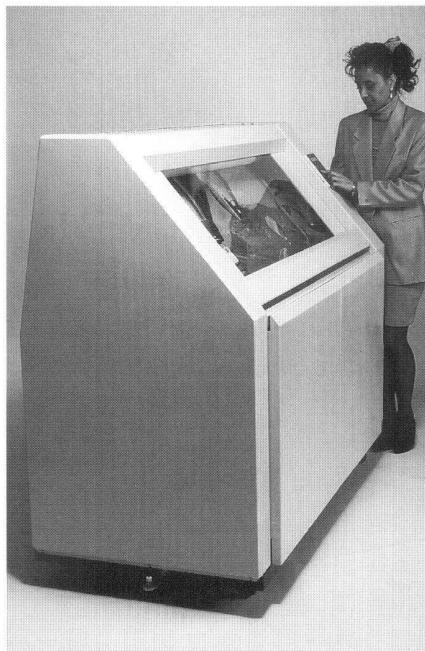
bei traditionellen Siebdruck- und Offset-Techniken nötig sind, kann verzichtet werden. Dank dieser neuen Technik erreicht man Durchlaufzeiten von etwas mehr als einer Minute pro m<sup>2</sup> Vierfarbendruck. Der Drucker verarbeitet Opaque- und Transparentpapier von 75–150 g sowie Polyesterfolie und kann Materialrollen von 151 Meter Länge aufnehmen.
