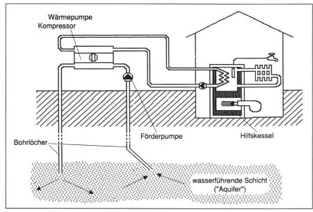
Abb. 1: Prinzipschema tiefe Geothermie (Schema: BEW).
