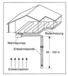
Abb. 5: Prinzipschema Erdwärmesonden und Wärmepumpe (Schema: BEW).
